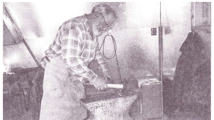
Etwa insgesamt 10.000 Schmiedenägeln entstehen hier durch Rüdiger Büchse in dieser Schmiede, die eigens für den Koggenbau hergerichtet wurde.
